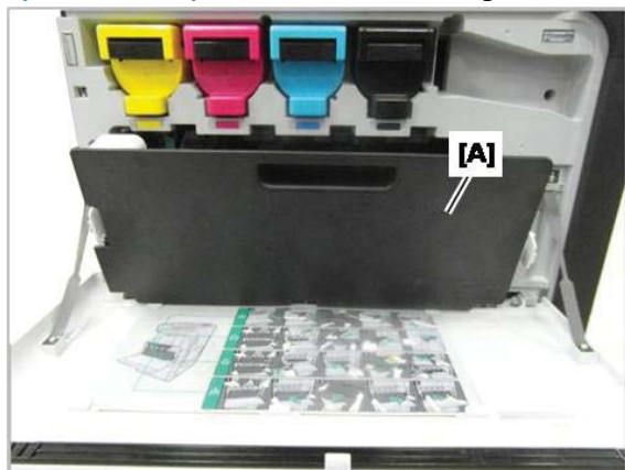
Rysunek 7-3 Wymiana modułu zbiorczego tonera
